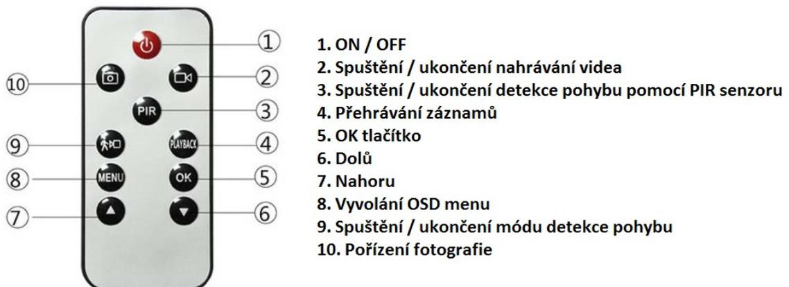
1. Ein/Aus, 2. Einschalten/Beenden Videoaufnahme, 3. Einschalten/Beenden der Bewegungserkennung mittels PIR Sensor, 4. Wiedergabe der Aufnahmen, 5. Taste OK, 6. Unten, 7. Oben, 8. Abrufen des OSD Menüs, 9. Einschalten/Beenden des Bewegungserkennungsmodus, 10. Foto machen
