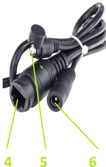
4. Schließen Sie die Kamera über LAN an den Router an.
